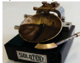
Figura 15 – Execução do ensaio no aparelho Casagrande
