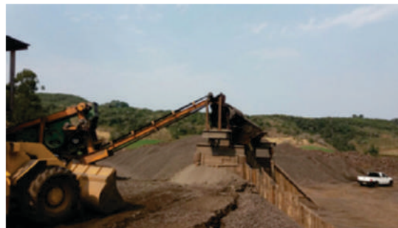
Figura 2 – Central de britagem em um dos garimpos de Ametista do Sul.
