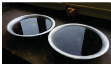
Figura 12 – Agregado graúdo imerso em água por 24h.
