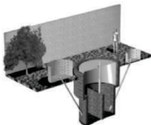
Figura 1 - Representação tridimensional em corte do biodigestor modelo indiano.
