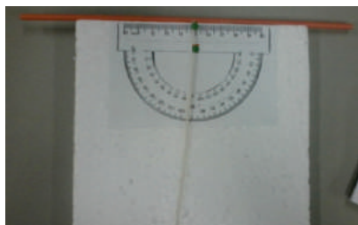
Figura 2 – Teodolito Confeccionado pelos licenciandos
