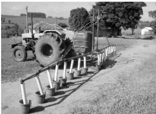
Figura 6 – Exemplo de trator sem estrutura de proteção contra capotamento (EPCC). Santa Maria, RS, 2008.
