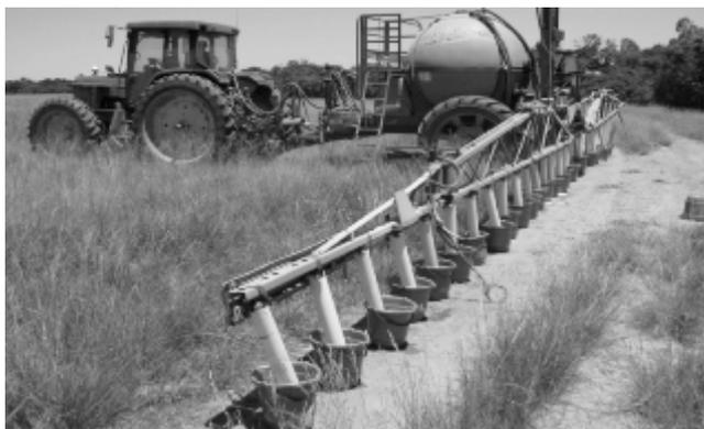
Figura 1 - Determinação de vazão por ponta de pulverização em pulverizador com engate de arrasto. São Sepé, RS, 2008.
